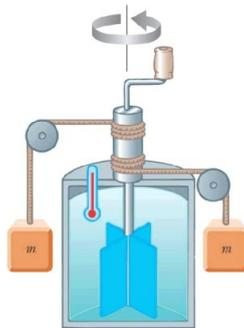
Abbildung 1: Aufstellung des Versuches von Joule.
